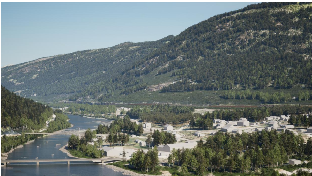
Figur 7-5 Illustrasjonen viser at fjernvirkningen av tiltaket med eksponerte støyskjermingstiltak, fyllinger og fjellskjæringer mot vest. Bevaring og etablering av ny vegetasjon mellom dagens E6 og nytt veianlegg vil ha stor betydning for å redusere tiltakets påvirkning på landskapsbildet.
