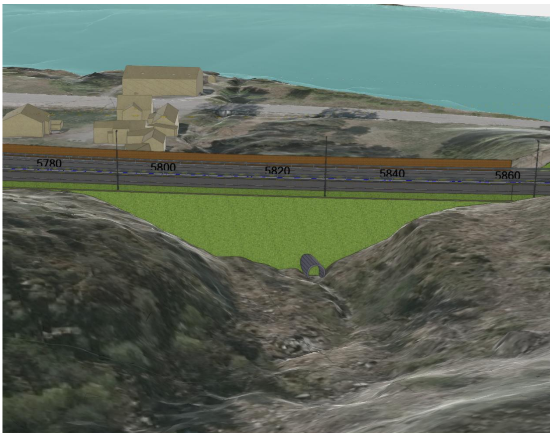
Figur 13-5. Skisse av betongrør ved Sandbuvangen som skal kunne fungere som passasje for mindre vilt, sett fra nord.
