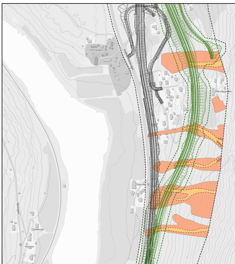
Figur 9-3 Utløpsområder for jord- og flomskred mellom Stanviki og Holsetervegen. Alternativ 1C er vist med svart geometri og alternativ 1I er vist med grønn geometri.
