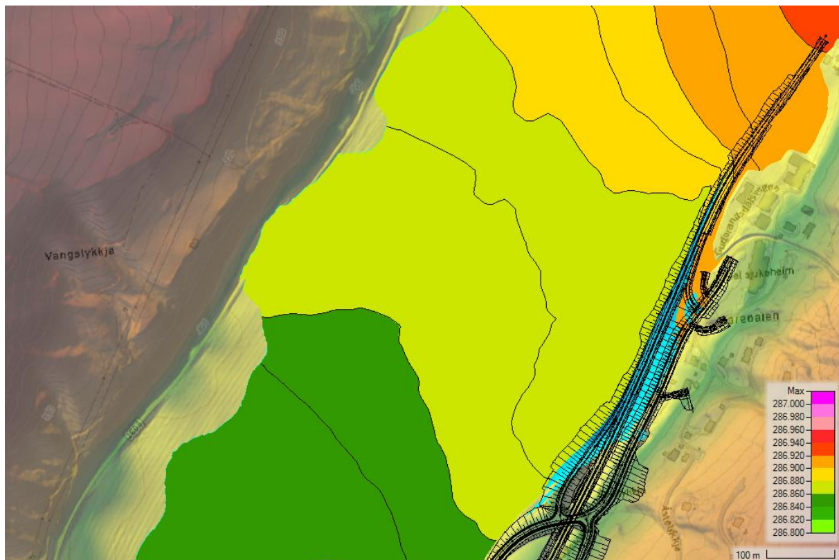
Figur 10-4 Modellert «fortrengt» flomareal ved 200-årsflom som følge av veifyllingen ved Sandbumoen/Bredevangen. Blått areal er eksisterende 200-årsflomareal som fortrenses av veianlegget. Øvrig farget areal er 200-årsflomsone.
