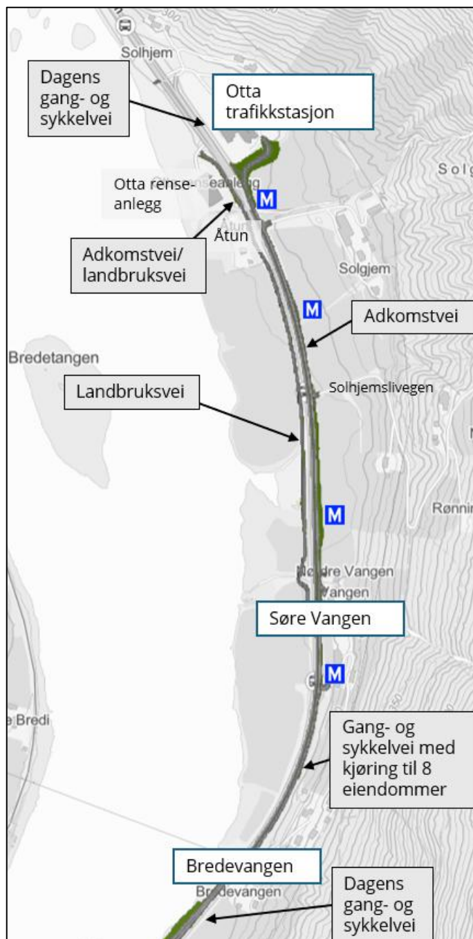
Figur 6-21 Skjematisk illustrasjon av ts-tiltakene mellom Bredevangen og Solhjem
