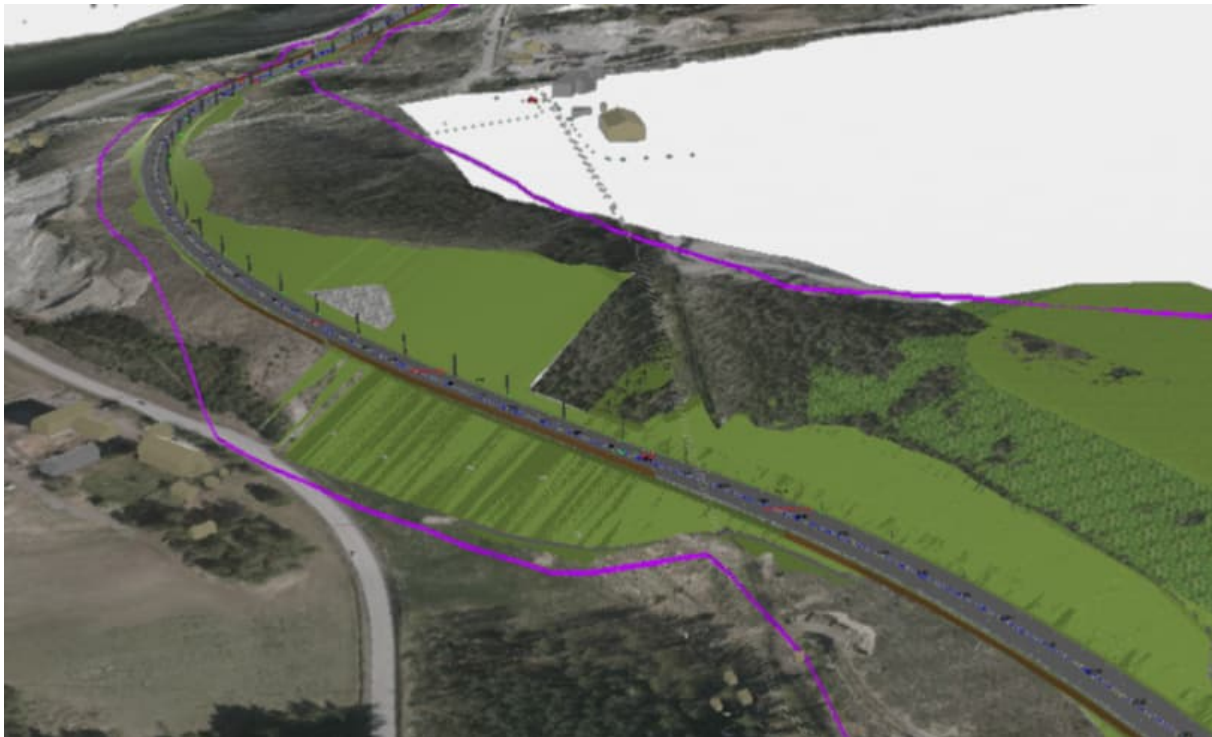
Figur 7-13: Fylling og skjæring ved grusuttak Sandbumoen. Utklipp tatt ut fra 3D-modell i Trimble connect.
