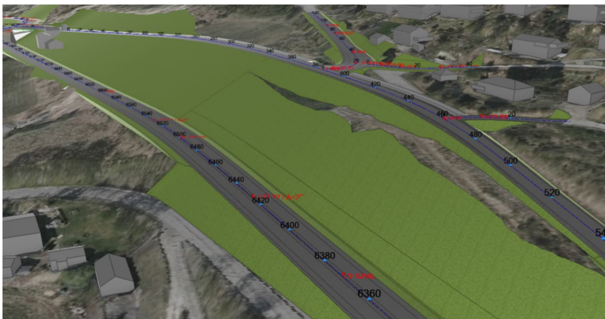
Figur 3-5: Løssmasseskjæring ved Sandbumoen tatt ut ifra 3D-modell i trimble connect.
