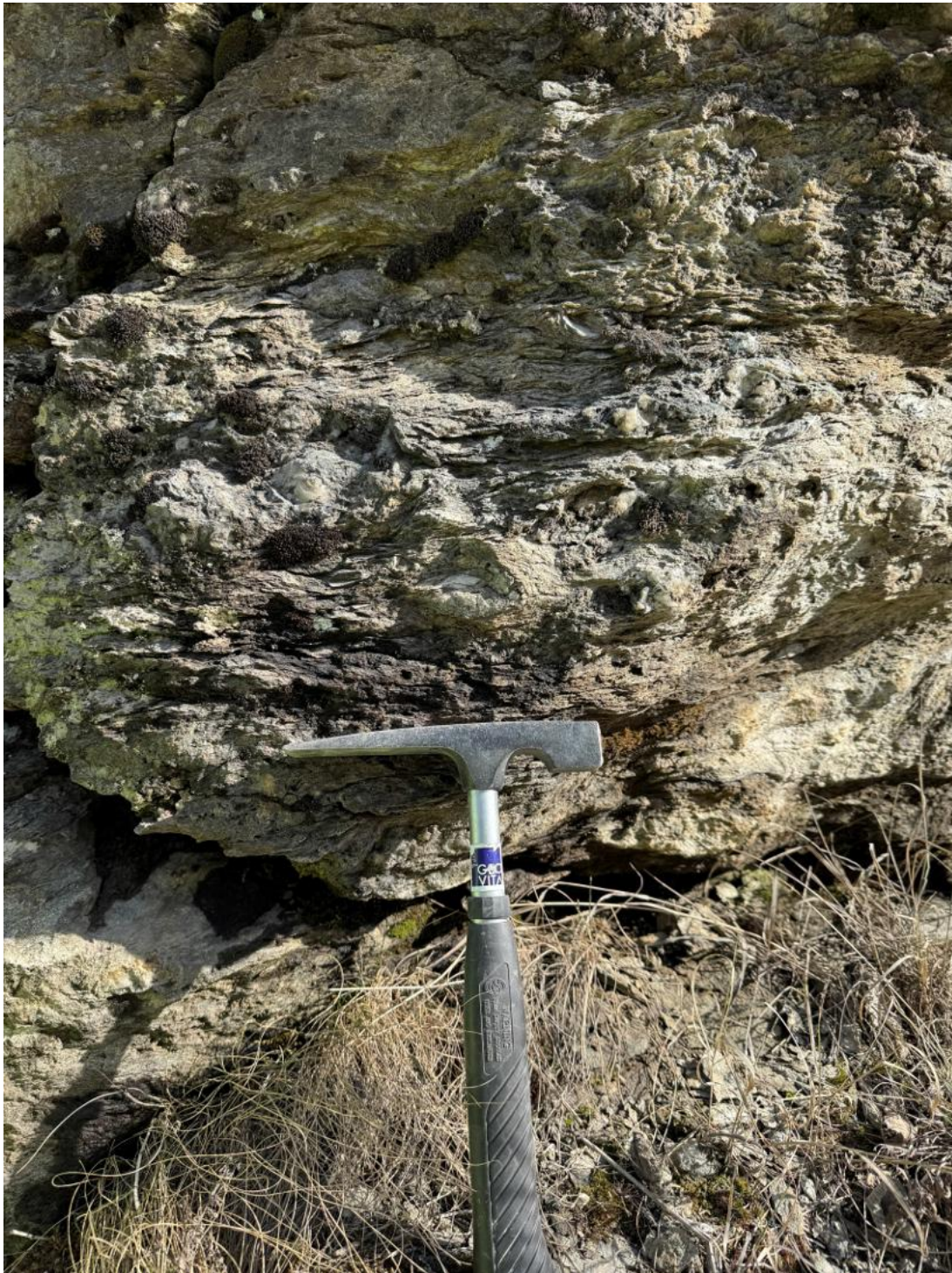
Figur 4-8 Diamiktitt observert ved ca. profil 2100 i eksisterende bergskjæring langs E6. Grålig matriks med en usortert struktur. Flere karbonatboller og bånd. Subhortisontal åpen sprekk kan ses i nedkant av bilde.
