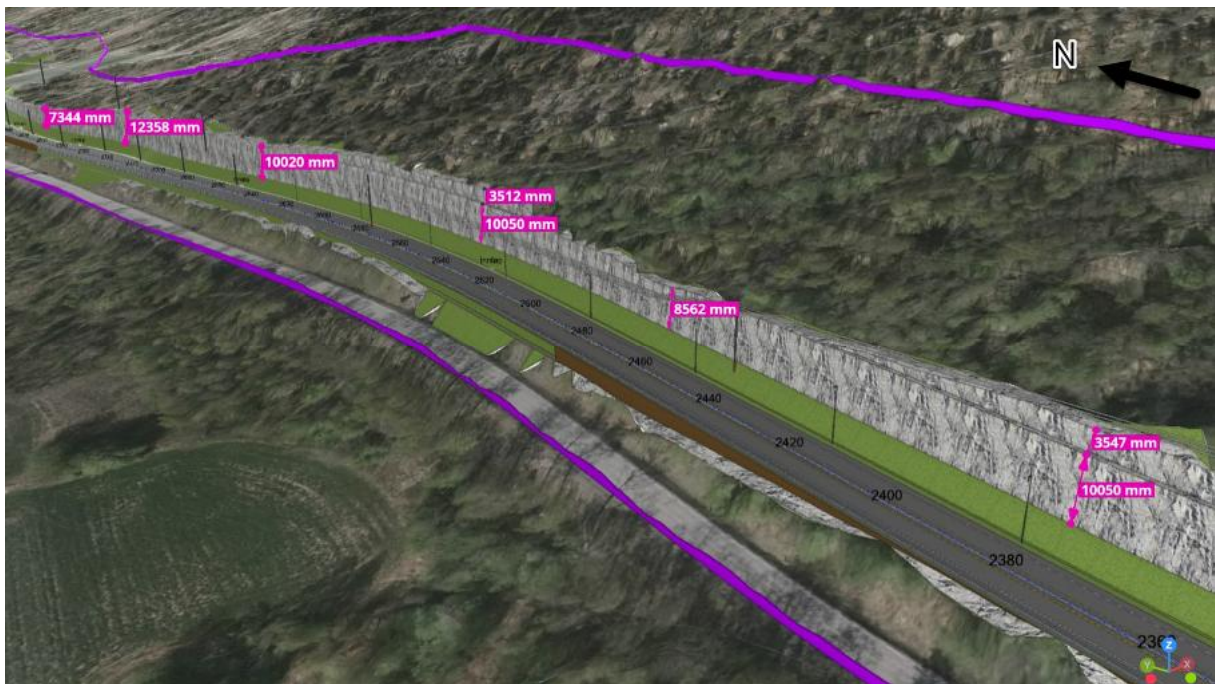
Figur 1-5 Utklipp fra Trimble-modellen. Utklippet viser bergskjæring ved profil 2300-2950. Angitt målt høyde er omtrentlig. Lilla linje er anleggsgrense.
