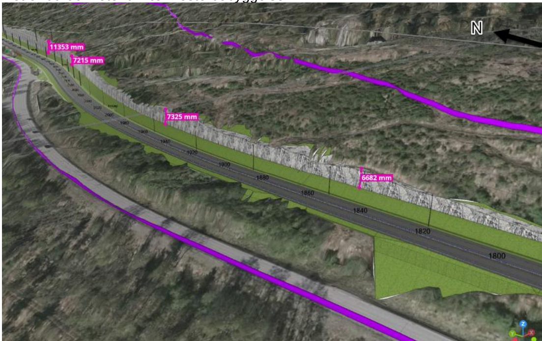
Figur 1-4 Utklipp fra Trimble-modellen. Utklippet viser bergskjæring ved profil 1800-2300. Angitt målt høyde er omtrentlig. Lilla linje er anleggsgrense.
