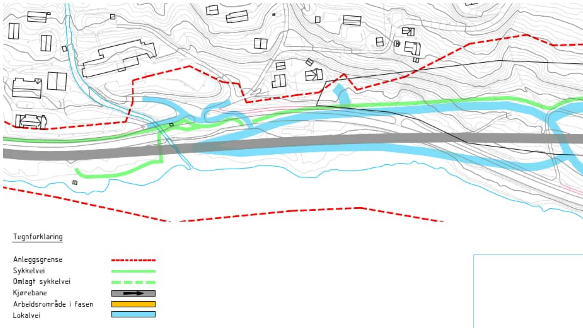
Figur 6.3.11 Faseplaner avkjøring Sel sjukeheim. Veisystem ferdig.
