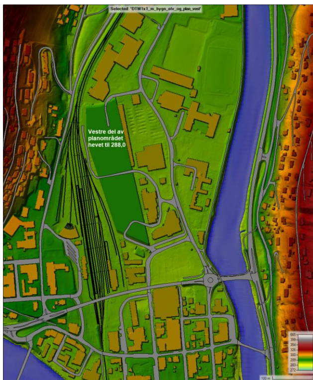
Figur 14 Situasjon med kun terrengheving på vestre del av sagbrukstomta.
