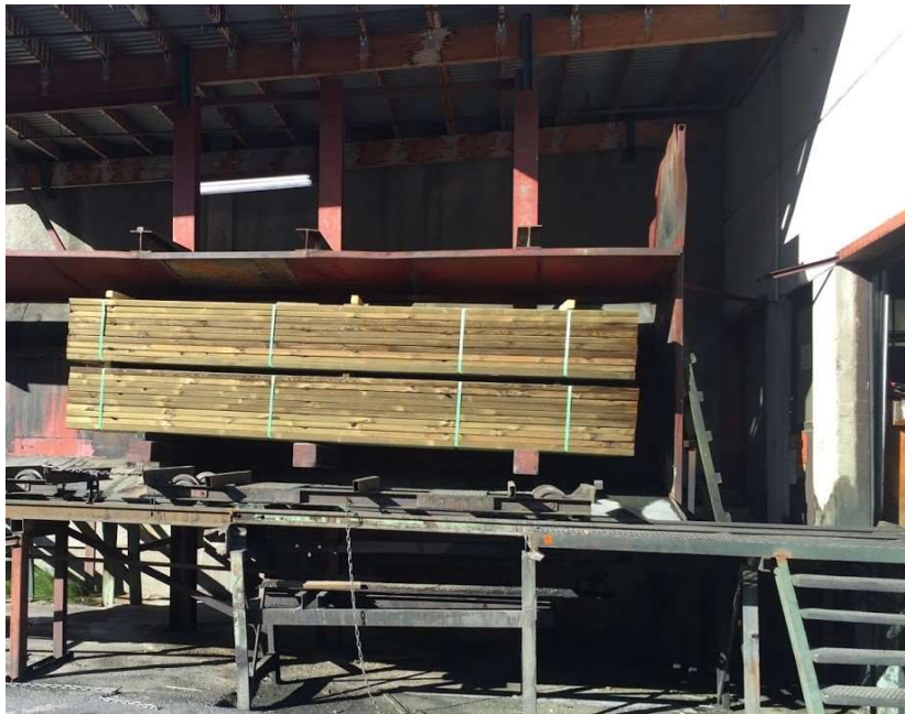
Bilde 2: Ferdig impregnerte materialer på skinneplattform med drypparrangement.
