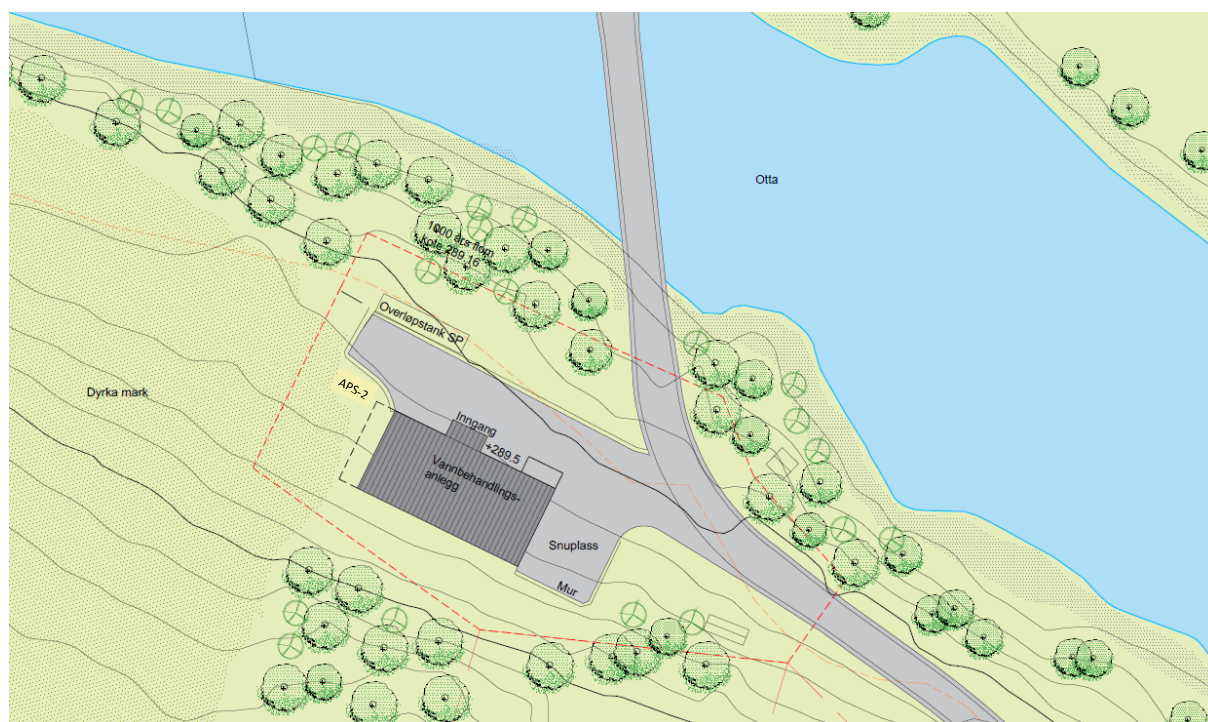
Figur 13: Utsnitt fra landskapsplan som viser nytt bygg for vannbehandlingsanlegg med parkeringsareal og adkomstveg.
