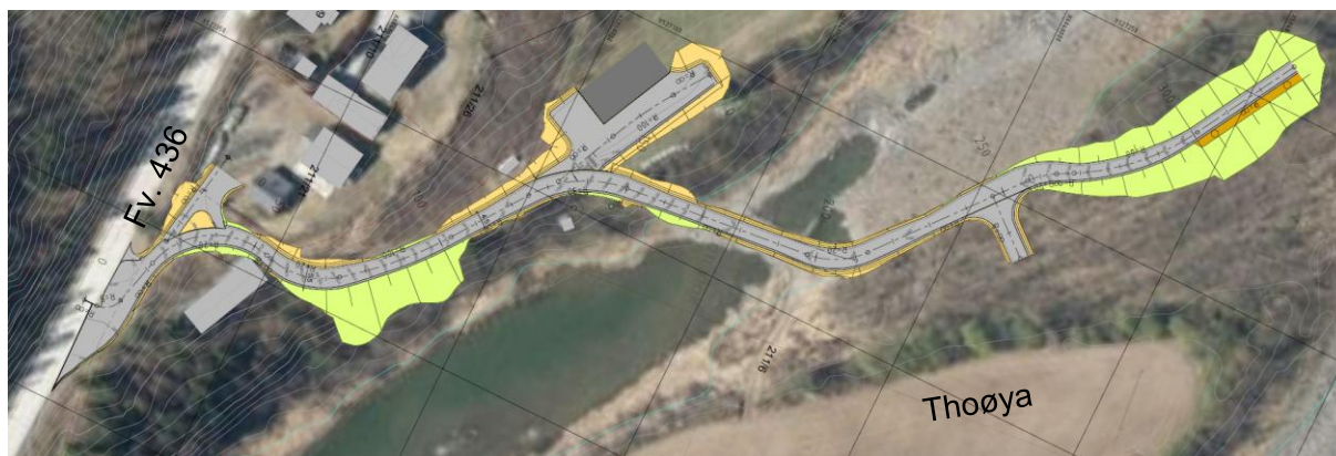
Figur 17: Plantegning for opprusting av veg mellom fv. 436 Veggumsvegen og Thoøya.
