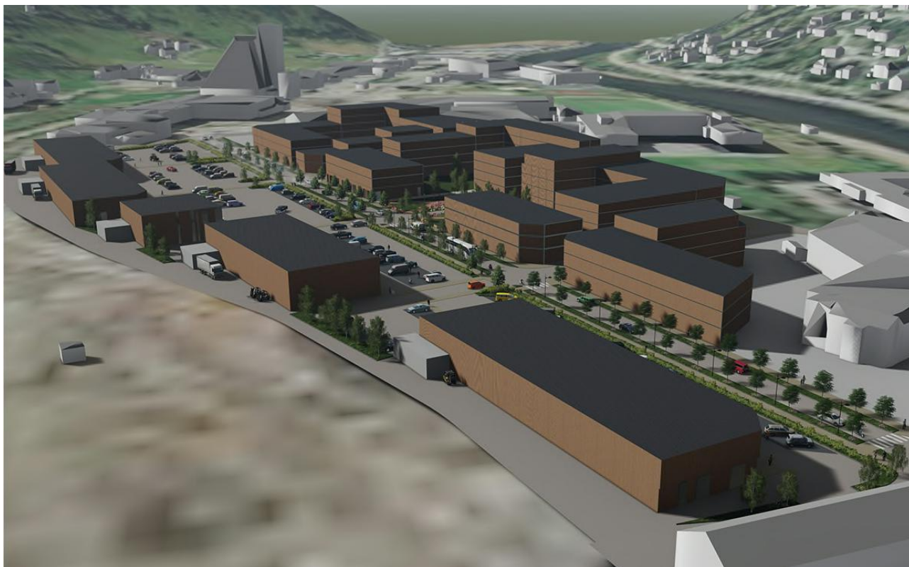
Figur 21. Illustrasjonen viser bebyggelse (forretning/tjenesteyting) i høy en etasje vest for forlengelsen av Johan Nygårds gate og bebyggelse i øst (bolig/forretning/kontor/tjenesteyting) med tre etasjer mot forlengelsen av Johan Nygårds gate og fire til fem etasjer mot Skansen. Kilde: Norconsult
