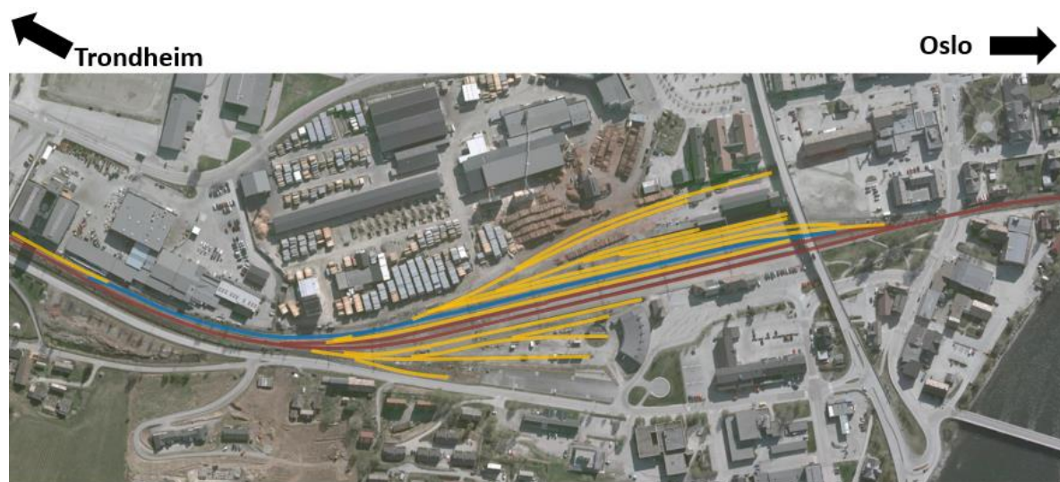
Figur 5-3 Oversikt over dagens spor. Rød= spor 1 og 2, blå=spor 4, gul= drifts- og vedlikeholdsspor. Kilde: Bane NOR
