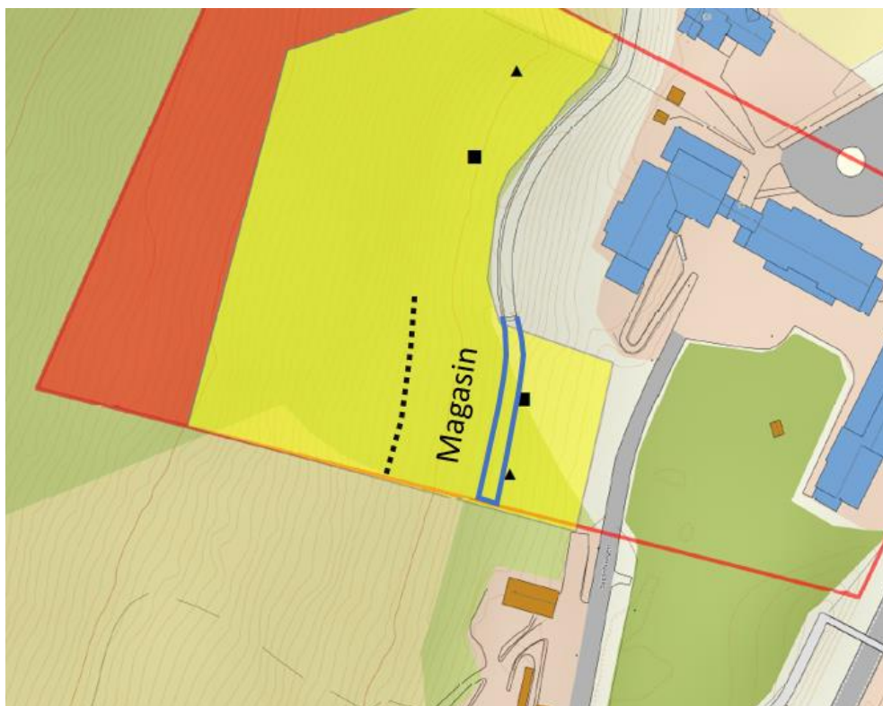
Figur 5-2. Anbefalt linjeføring ved forlengelse av voll, markert med blå linje. Svart stiplet linje markerer ca. øvre grense for terrenginngrep. Illustrasjon: Norconsult AS.
