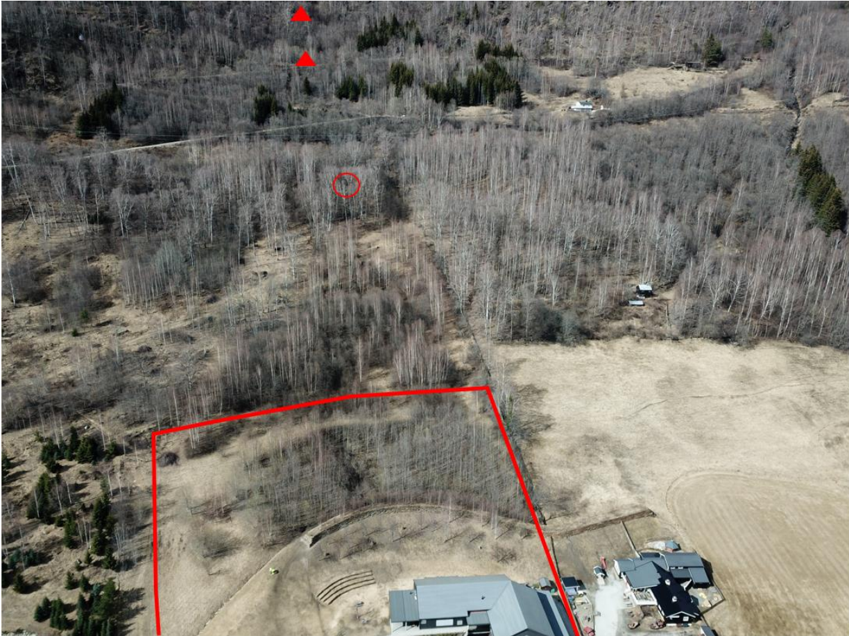
Figur 18. Registreringsområde tatt med drone. Rød linje markerer en del av vurdert område. Rød sirkel markerer nederste blokk relatert til steinsprang. Trekanter markerer dårlig drenering og sig i løsmasser.
